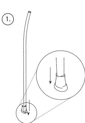
SE- Montera doppskon på kryckan nedre del. Håll kryckröret vertikalt under resterande monteringsmoment.
