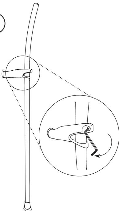
ES- Apriete el tornillo con la llave allen hasta que sienta resistencia. Luego dé otra media vuelta sin forzarlo. No exceda los 3 nxm.
