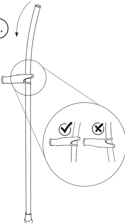
ES- Deslice cuidadosamente el mango por el tubo hasta la altura deseada.
