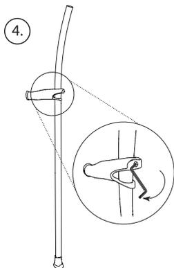
SE- Dra åt skruven med den medföljande insexnyckeln till ett motstånd känns. Dra därefter ytterligare ett halvt varv.
